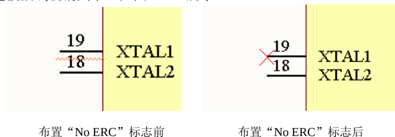
图 2.108 布置“No ERC”标志前后的引脚
