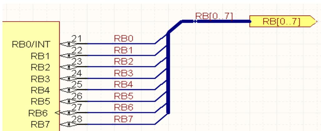
图 48: 用参考系统定义的总线
