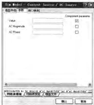
图 7-16 直流电源的仿真参数
