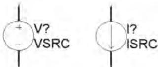
图 7-15 直流电压源、直流电流源符号
