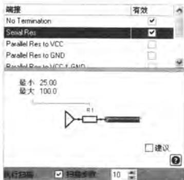
图 12-54 设置串阻补偿参数扫描
