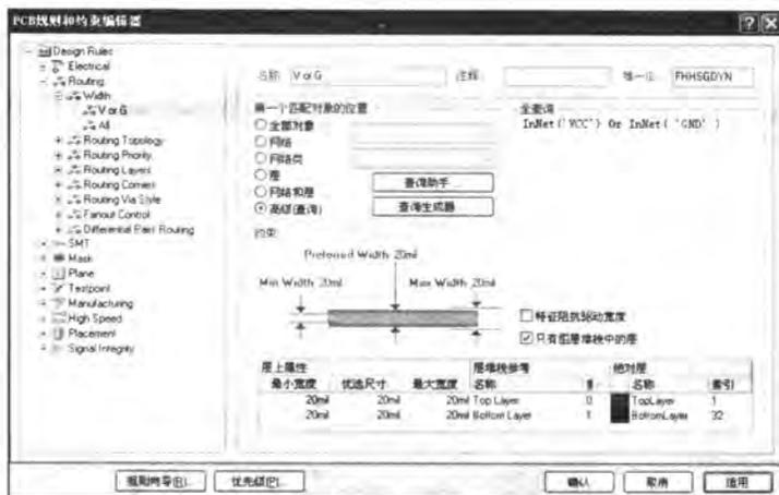
图 9-39 完成第 2 个导线宽度规则设置
