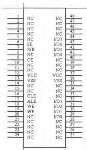
图 5-50 K9F1G08 的原理图符号
