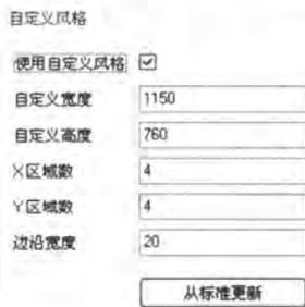
图 3-10 自定义图纸尺寸
