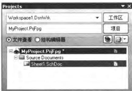
图 2-48 创建一个原理图文件
