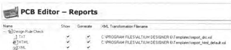
图 11-11 设置“TXT”及“XML”格式
