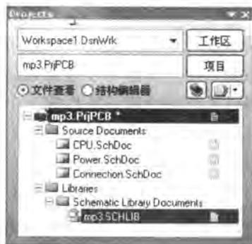
图 4-40 新建原理图库文件
