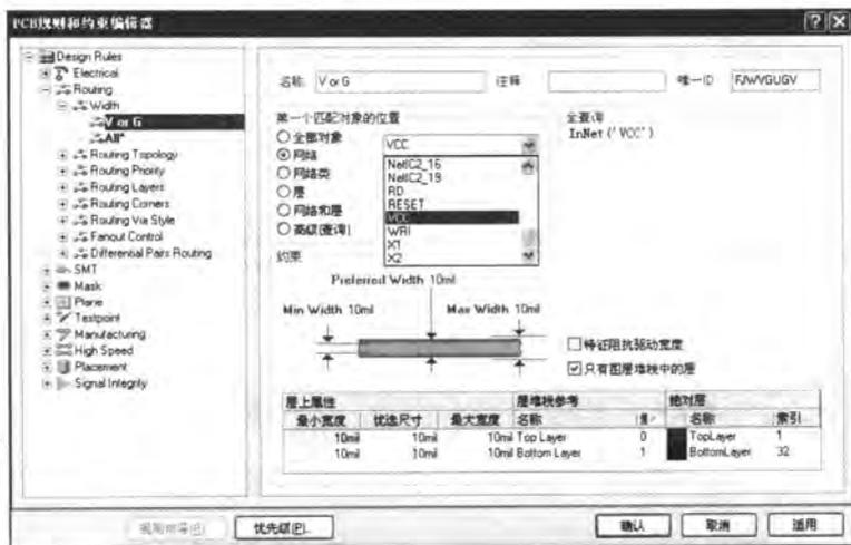
图 9-37 第 2 个导线宽度规则设置
