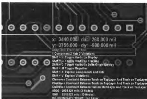
图 11-10 窗口转换及违规定位
