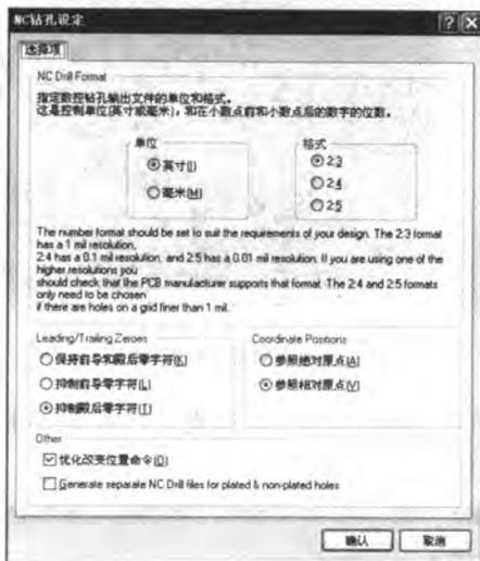
图 11-53 【NC 钻孔设定】窗口
