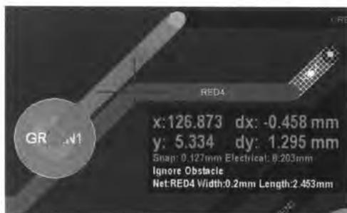
图 9-73 拖动时添加新的导线段 (Ignore Obstacle 模式)
