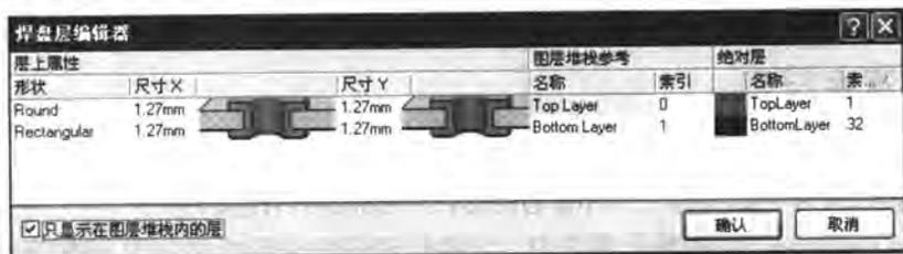
图 8-59 【焊盘层编辑器】对话框
