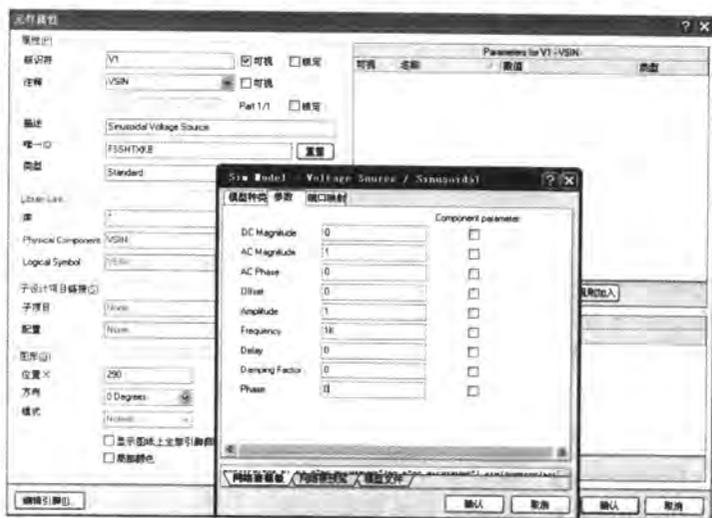
图 7-28 正弦电压激励源参数设置
