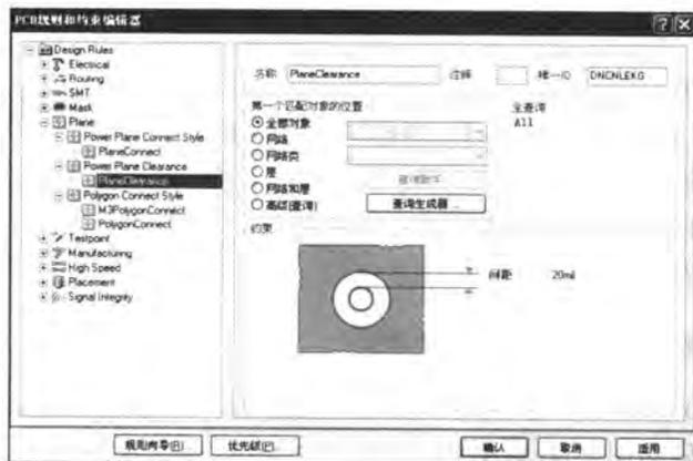
图 9-87 【Power Plane Clearance】规则设置
