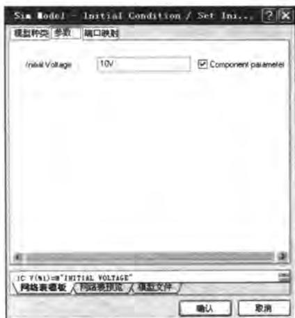
图 7-6 “.IC”元器件仿真参数
