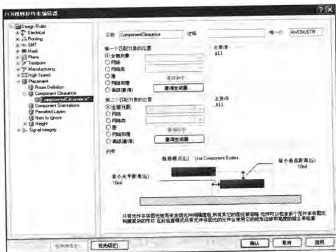
图 9-5 【Component Clearance】规则设置
