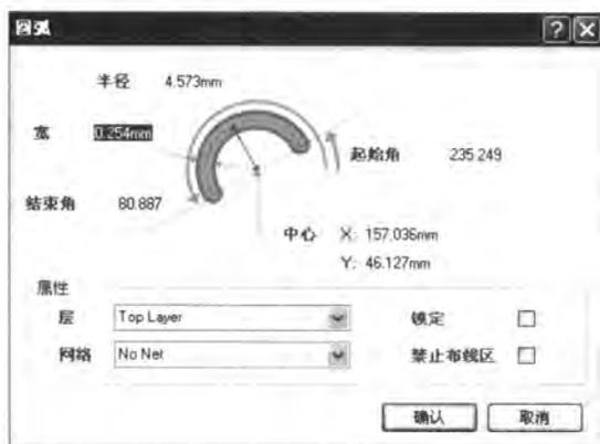
图 8-74 圆弧属性设置
