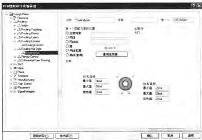
图 9-47 【Routing Via Style】规则设置
