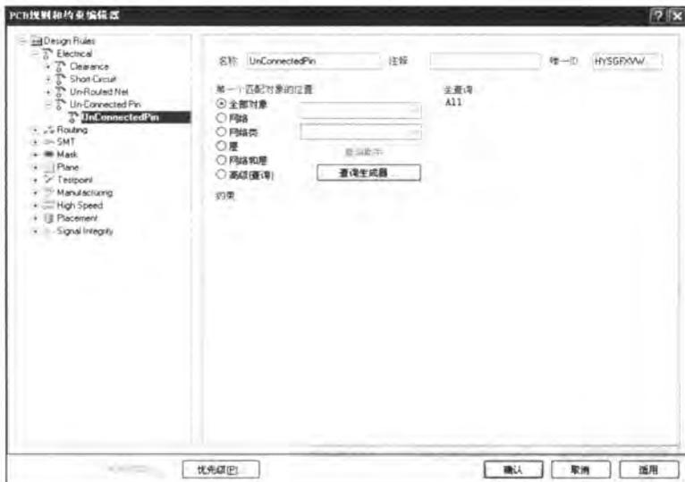
图 9-33 【UnConnected Pin】规则设置
