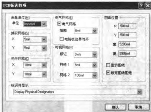
图 8-108 设置 PCB 工作参数
