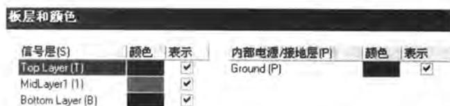
图 9-81 选中内电层的【表示】复选框
