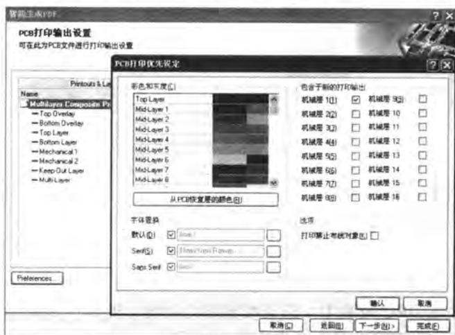
图 11-77 设定打印灰度
