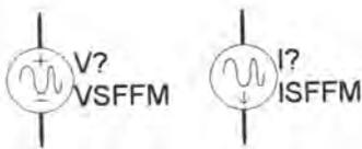
图 7-25 调频电压源、电流源符号
