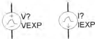
图 7-23 指数电压源和指数电流源符号
