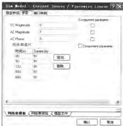
图 7-22 分段线性激励源的仿真参数
