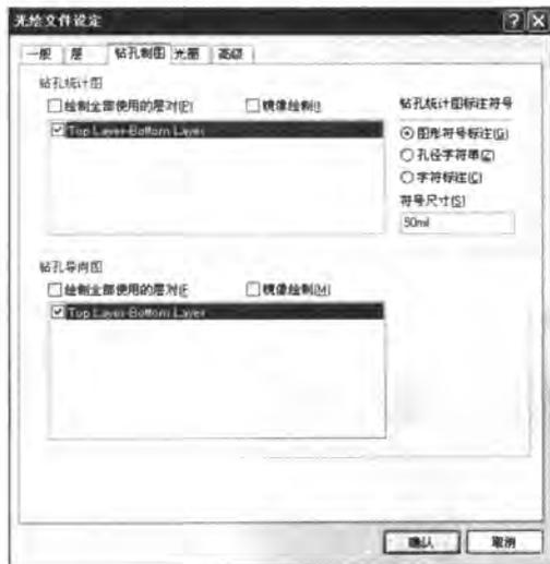
图 11-49 【钻孔制图】标签页设置
