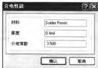
图 8-96 绝缘层属性设置
