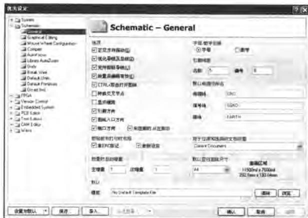
图 3-18 原理图【优先设定】对话框(【General】标签页)
