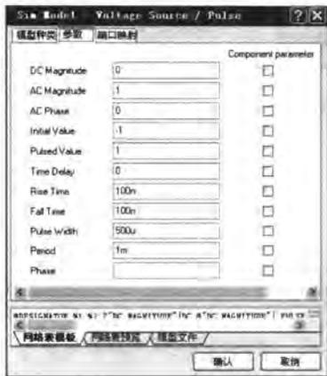
图 7-64 “VPULSE”的仿真参数设置
