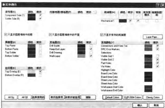
图 8-121 设置工作层面的显示及颜色
