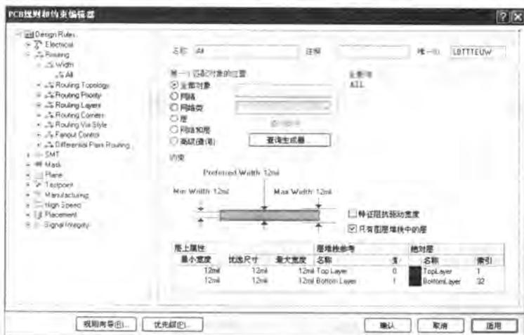
图 9-36 第 1 个导线宽度规则设置
