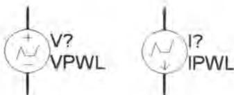
图 7-21 分段线性电压源和分段线性电流源符号
