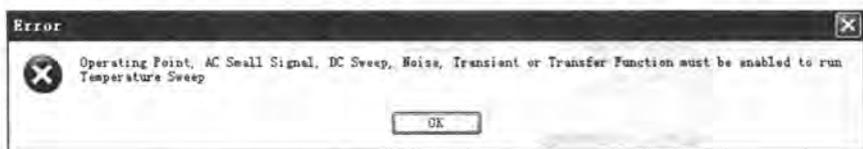
图 7-40 与温度扫描相配合的仿真方式选择提示框
