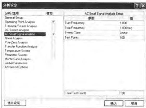
图 7-35 【AC Small Signal Analysis】选项窗口
