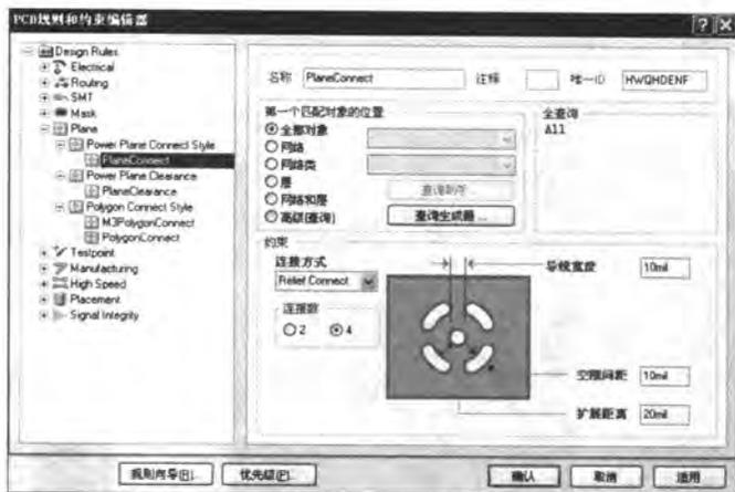
图 9-86 【Power Plane Connect Style】规则设置
