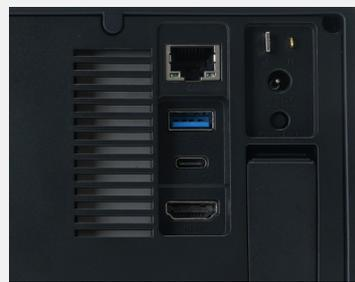
▶ 标配 USB3.0 Host、Type-C、LAN、HDMI、校准方波输出接口（可切换 Trigger out），满足用户多样化的连接需求，提升测试工作的灵活性与便捷性。
