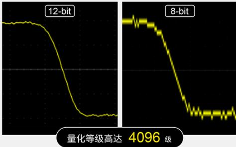
▶ MHO 1 系列示波器凭借其内置的 12 位高分辨率 ADC，在波形采集和分析方面实现了显著的技术飞跃。相较于传统的 8 位示波器，12 位 ADC 提供了 16 倍的波形细腻度提升，这一特性对于精确捕捉和分析信号特征至关重要。
