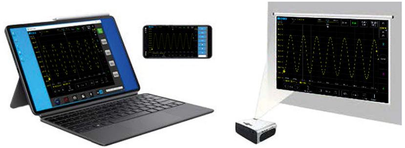
▶ MHO 1 系列支持使用上位机或手机 app 进行远程控制示波器，支持 HDMI 投屏，用户可以实时看到示波器的使用界面，并操作示波器的所有功能。支持使用 SCPI 指令控制示波器，更加灵活高效地帮助用户实现自动化测量，提高工作效率。
